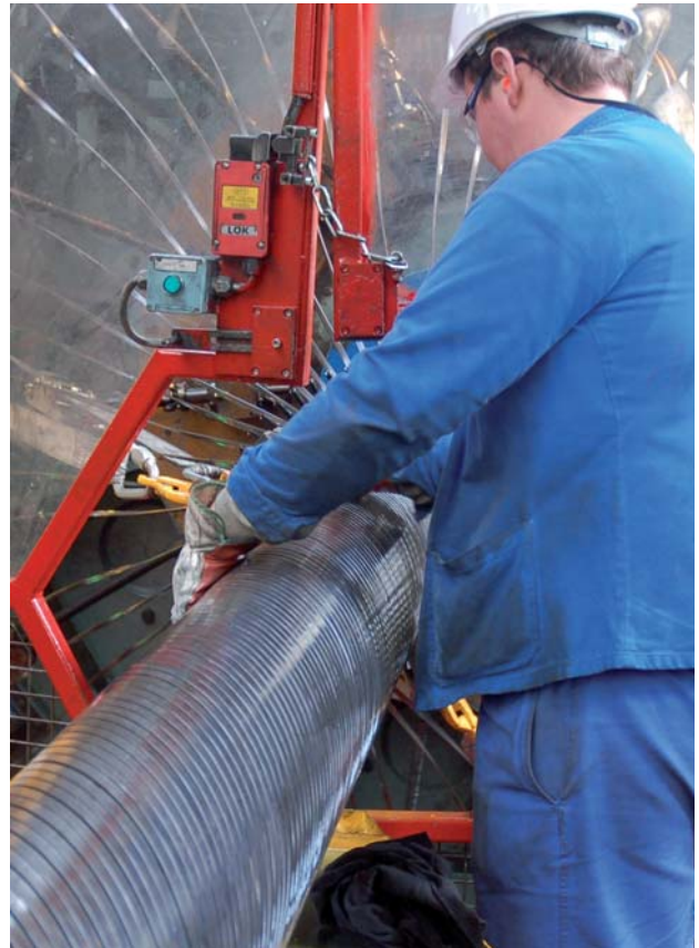
●●● Contrôle manuel de flexible en sortie d'armeuse à l'usine du Trait, France.
